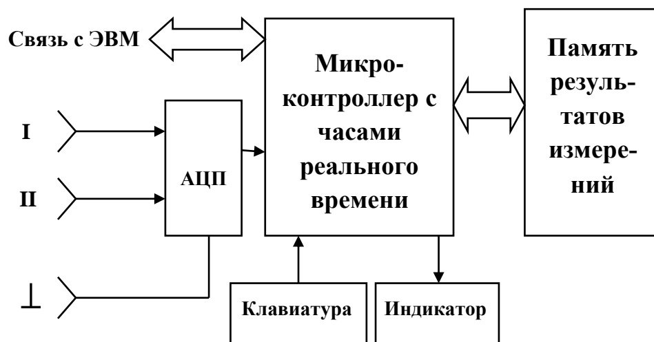
Рисунок 2 – Структурная схема Регистратора
